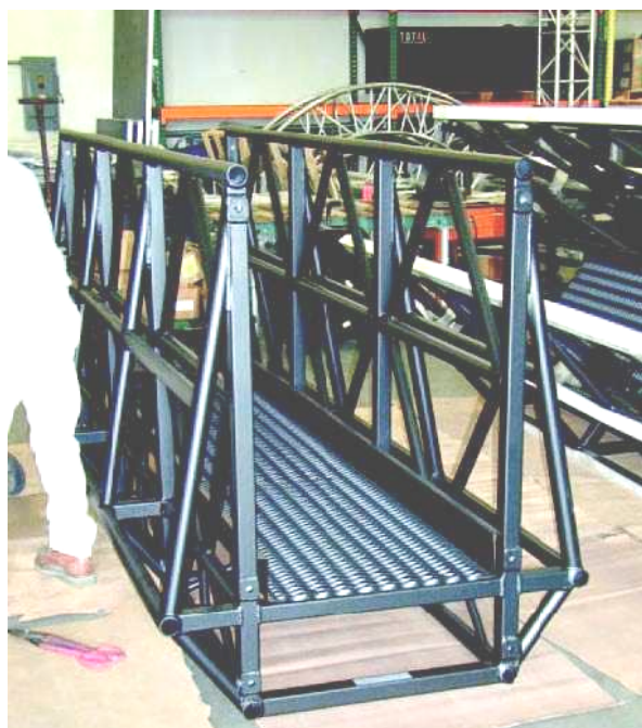
Hình 13.09: Giàn khung catwalk.
